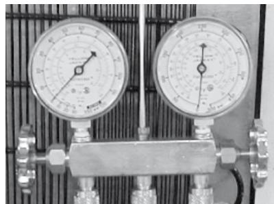
برخی اوقات، فشارسنج‌ها نیازمند تنظیم مجدد هستند. اکثر فشارسنج‌ها مجهز به یک پیچ تنظیم هستند که معمولاً بر روی صفحه فشارسنج تعییه شده است. این دسته از فشارسنج‌ها را می‌توان بدون نیاز به اعمال فشار بر روی عدد صفر تنظیم نمود.
