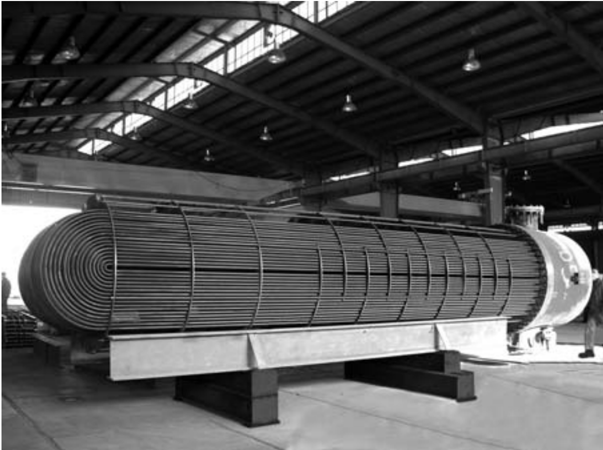
شکل ۹: تیوب باندل میدل E-5005 به وزن تقریبی ۱۷ تن و طول ۸/۵ متر با تیپ BEU به سفارش شرکت پیدک پروژه MEG خارگ - ساخته شده توسط شرکت فاتح صنعت کیمیا
