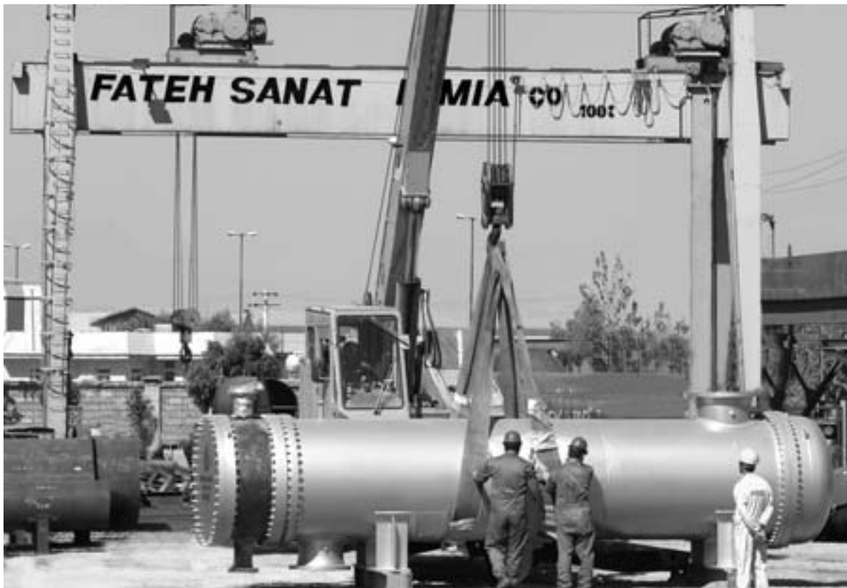
شکل ۷: مبدل E-01028C به وزن تقریبی ۱۶/۵ تن و طول ۷/۵ متر از جنس AL-BRONZE با تیپ (AES TEMA TYPE) به سفارش مشارکت IGC & ODCC - پروژه رفع تنگناهای پالایشگاه بندرعباس - ساخته شده توسط شرکت فاتح صنعت کیمیا (شکل ۶)
