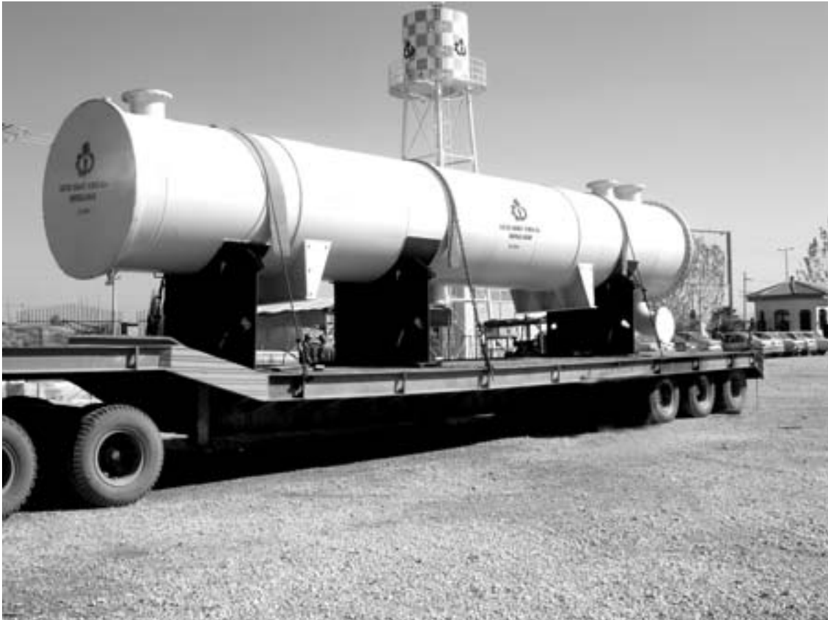
شکل ۴: مبدل E-2301 به وزن تقریبی ۷۰ تن و طول تقریبی ۱۳ متر با تیپ NEN مربوط به شرکت فرآورش بندر امام (BIPC) - ساخته شده توسط شرکت فاتح صنعت کیمیا
