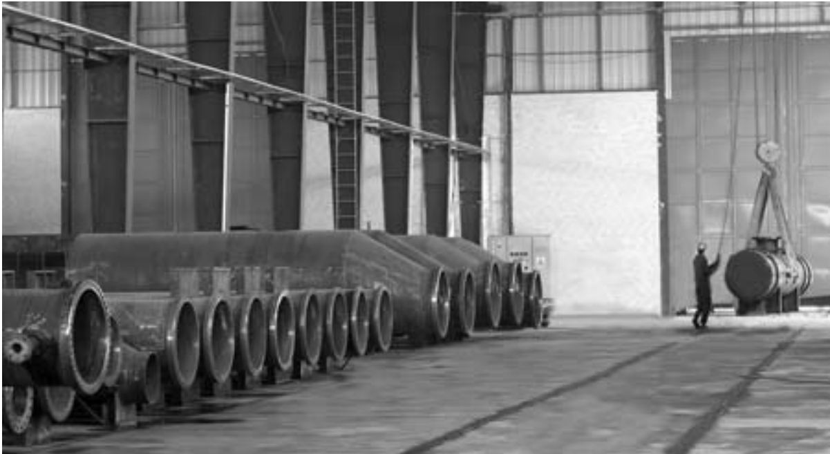
شکل ۱: نمایی از پوسته مبدل‌های تیپ‌های مختلف TEMA در حال ساخت در یکی از سالن‌های مونتاژ مبدل‌های پوسته لوله شرکت فاتح صنعت کیمیا
