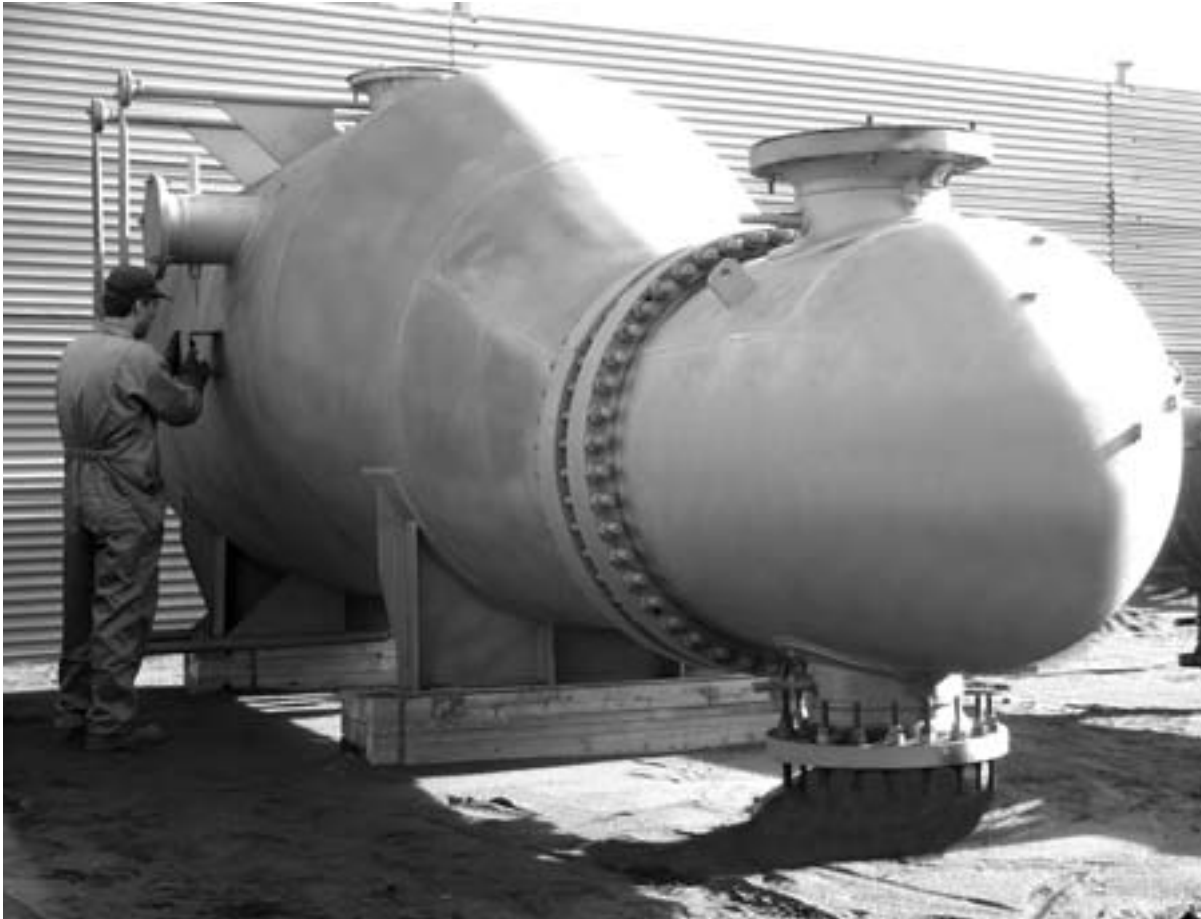
شکل ۳: مبدل E-705 به وزن تقریبی ۵ تن و طول ۶ متر از جنس SA-516 Gr70N با تیپ BKU به سفارش شرکت مهندسیین مشاور نارگان - پروژه اتیلن الفین خارگ- ساخته شده توسط شرکت فاتح صنعت کیمیا
